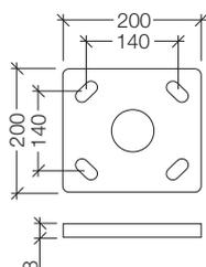
Flangia per installazione su plinto/pavimentazione:
