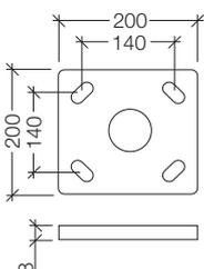
Flangia per installazione su plinto/pavimentazione:
