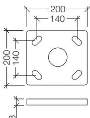
Flangia per installazione su plinto/pavimentazione:
